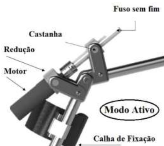
Figura 2: Mecanismo de acionamento das articulações (Fonte: : BASTOS et al., 2017)
