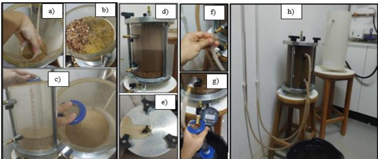
Figura 1. Procedimento do ensaio de permeabilidade.
