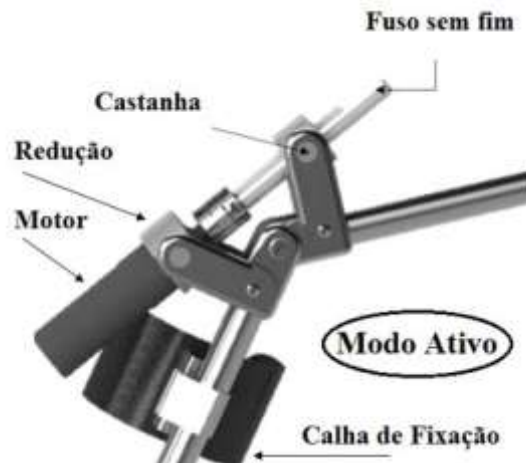
Figura 2: Mecanismo de acionamento das articulações (Fonte: : BASTOS et al., 2017)
